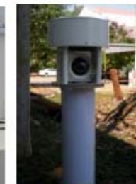
(12) 可動カメラ + 超小型 PC + 3G モデム
