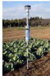
(13) 固定カメラ + 害虫カウンタ
