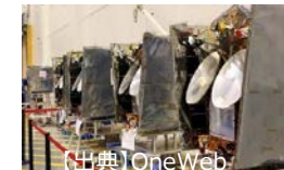
【出典】OneWeb 製造試験ラインを自動化しているOneWeb衛星
